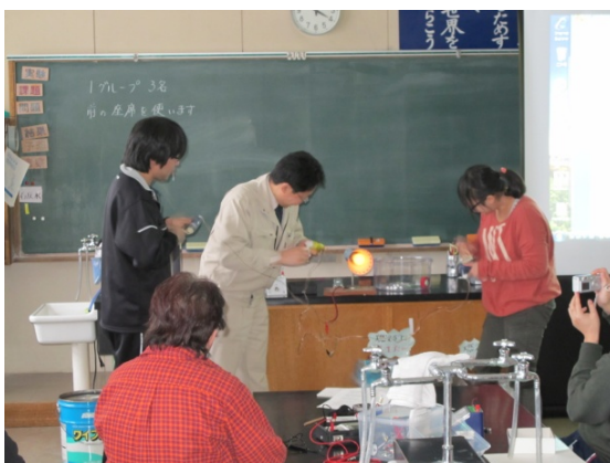
手回し発電機で100Wの電球を点灯
